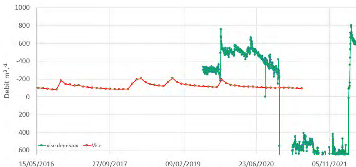
Figure 40 : Comparaison des débits de la Vise observés (vert) et simulés en régime transitoire au pas de temps mensuel (rouge) par le modèle MARTHE dans le cadre du projet Dem'Eaux Thau.
